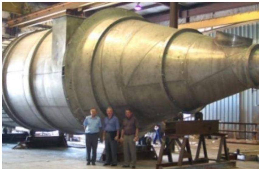
Mikropul Cyclone filter 迈克罗普旋风除尘器 Max 40 bar, any steel/alloy type etc 任何钢/合金类型 等 Above 25,000 is special design 25,000以上风量需特殊设计
