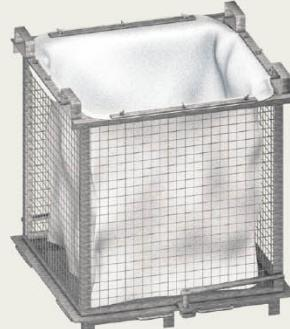
将污泥中的杂质捕捉在盒式的滤布中，在底部可以排渣，构造简单，可与各种自动逆洗过滤器搭配。
